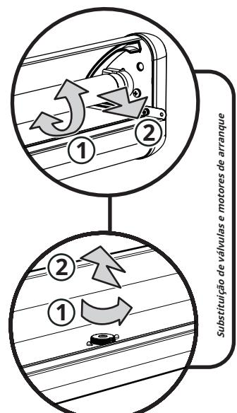
Substituição de valvulas e motores de arranque
